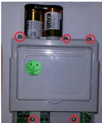
Figure 5: Retrait et mise en place de la carte de commande
