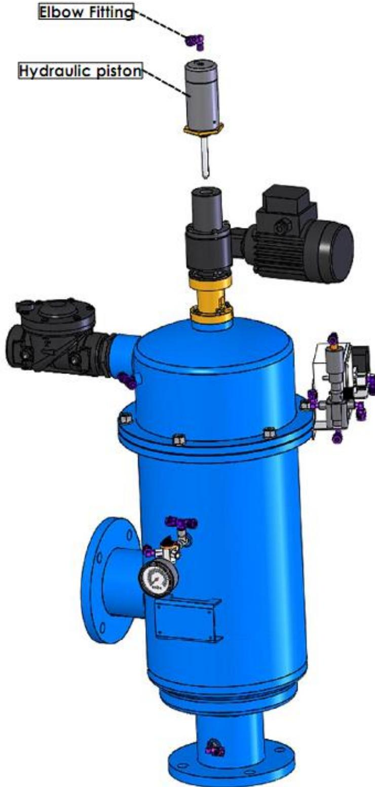
Figure 5: Retrait et installation du vérin hydraulique
