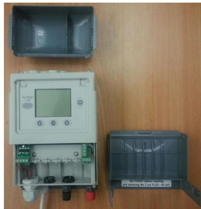
3. Выверните 5 винтов (красные кружки). Отключите кабель питания (для AC & DC голубой прямоугольник) Отключите датчик DP sensor и внешние датчики, если существуют – желтый прямоугольник)
